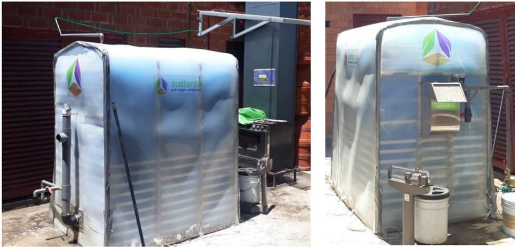
*Ilustración 2 - Biodigestor de la prueba piloto*
